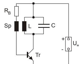
**Beispielrechnung:**  $C = 50 \text{ nF}; \quad L = 15 \text{ mH}; \quad \delta = 0,1 \cdot \omega$
