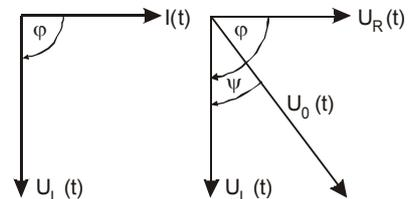
In beiden Fällen ist die Phasendifferenz  $\varphi$  immer konstant, während der Phasenwinkel  $\psi$  von der Frequenz abhängt und Werte von  $0^\circ$  bis  $90^\circ$  bzw.  $0^\circ$  bis  $-90^\circ$  annehmen kann. Aus trigonometrischen Überlegungen erhält man beim Kondensator für  $\psi$  die Beziehung
