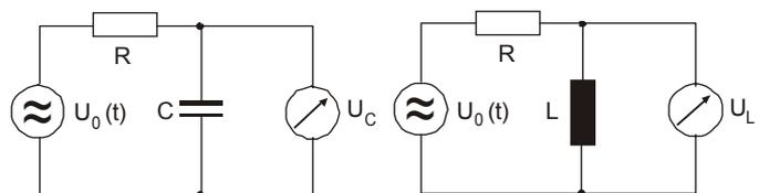
Bei Variation der Frequenz wird die Spannung  $U_C$  bzw.  $U_L$  in Abhängigkeit von der Frequenz gemessen, wobei die Amplitude der von der Spannungsquelle erzeugten sinusförmigen Wechselspannung als konstant angesehen werden kann.
