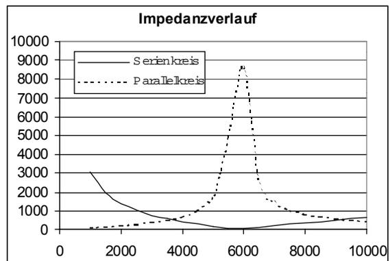
Der Spannungsverlauf ergibt sich nach Glg. (7.7) und ist in dem unteren Diagramm wiedergegeben. Da die für die Darstellung der Graphen zu Grunde liegende Tabelle nicht genau die Eigenfrequenz  $f_{res}$  des Parallelkreises trifft, wie sich nach Glg. (6.9) berechnen lässt, zeigt der Graph für den Parallelkreis keine Definitionslücke, wie sie nach Glg. (8.4) für  $X_L = X_C$  zu erwarten wäre.
